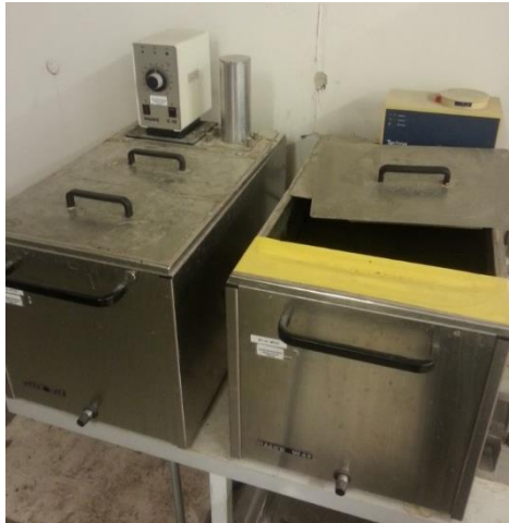
Figur 8: Konditionering av provkroppar i vattenbad i 40^\circ\text{C} i 68-72 timmar (enligt SS-EN 12697-12).
