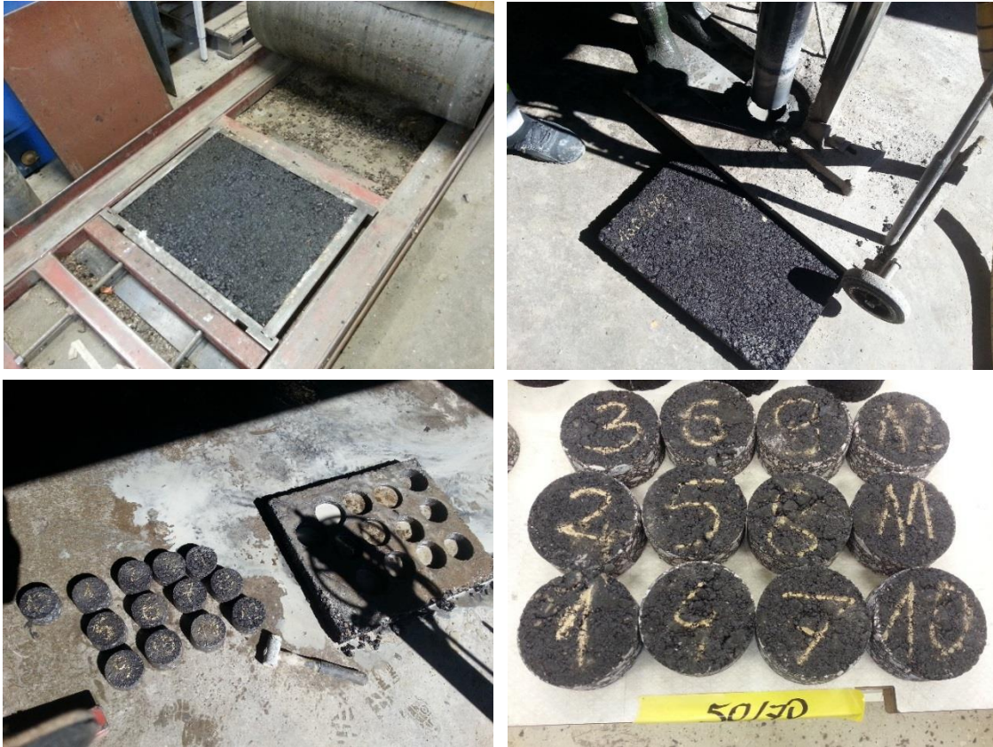
Figur 5: Tillverkning av plattor och borrning av provkroppar ur platta (enligt SS-EN 12697-33).
