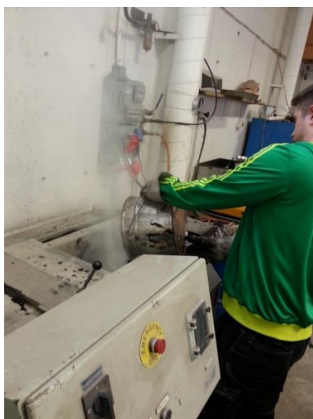
Figur 2: Massablandning i laboratorieblandare.
