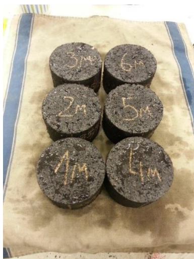
Figur 7: Marshallprovkroppar upptagna från vakuumsäckator och redo för volymmätning (enligt SS-EN 12697-29).
