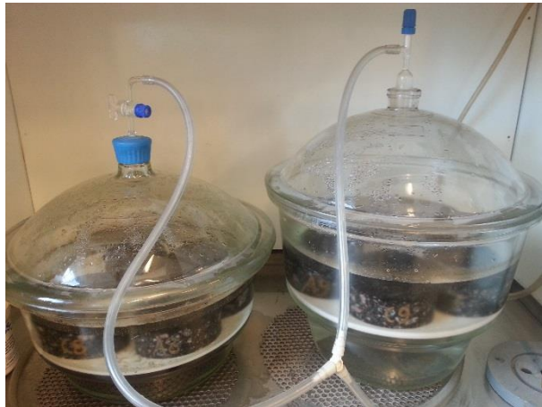
Figur 6: Provkroppar i vakuumsäckator, under vatten, undertrycket på 6,7 \text{ kPa} (enligt SS-EN 12697-12).
