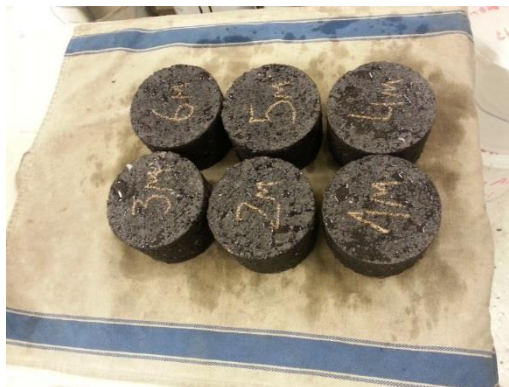
Figur 9: Provkroppar tagen ur från vattenbad och redo för volymmätning (enligt SS-EN 12697-29).
